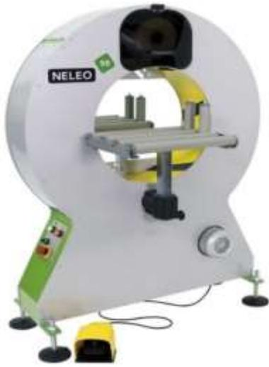
Banderolage, groupage et protection de produits longs tels que : moulures, barres d'aluminium, tubes, persiennes, etc.
