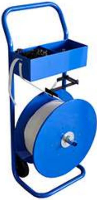
Chariot dévidoir mobile de grande polyvalence et adaptable aux bobines de feuillard de 25, 200, 280 et 406 mm de diamètre au niveau de leur mandrin intérieur. Economique et très facile à manier, ce dévidoir mobile polyvalent tout diamètre facilite le transport de la bobine de feuillard et la protège ainsi que son dévidage tout en s'adaptant à son
