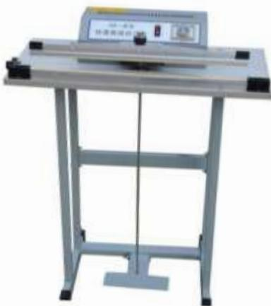
Machine de soudage a pédale, pour sacs en matière plastique thermo soudable, avec soudage par impulsion (de résistance à la chaleur pendant quelques secondes) et la minuterie pour le réglage. Le cycle de soudage est indiqué par un voyant lumineux. Les soudeuses permettent une production élevée, car l'enveloppe à souder est positionné avec les deux mains et
