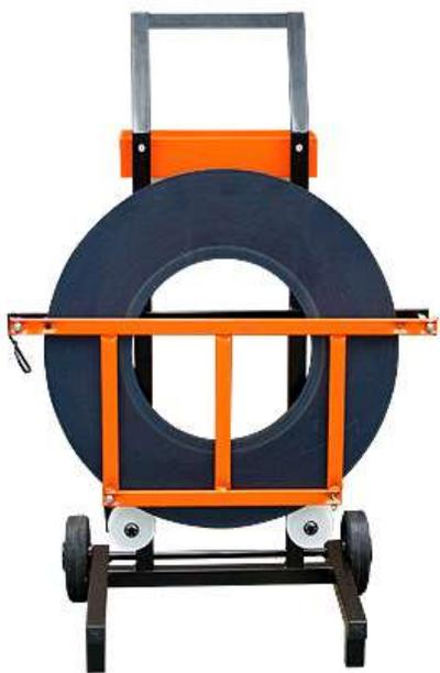
Chariot dévidoir mobile de grande polyvalence et adaptable aux bobines de feuillard , Economique et très facile à manier, ce dévidoir mobile polyvalent tout diamètre facilite le transport de la bobine de feuillard et la protège ainsi que son dévidage tout en s'adaptant à son diamètre.
